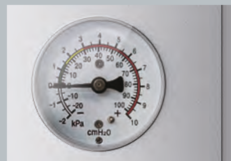
Μανόμετρο αεραγωγού για σύστημα διπλού κυκλώματος
